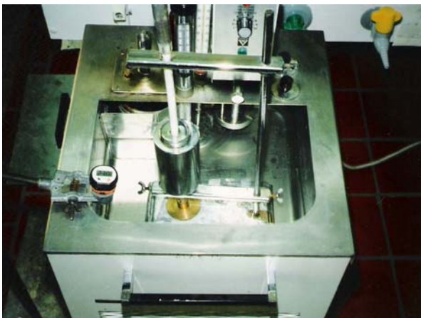
شکل ۲: دستگاه ویژه آزمون سیلان در حمام آب گرم در حین انجام آزمون
